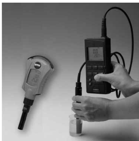
شکل ۶. استفاده از دستگاه های مخصوص اندازه گیری هدایت الکتریکی و مقاومت آب جهت تعیین خلوص آن.
