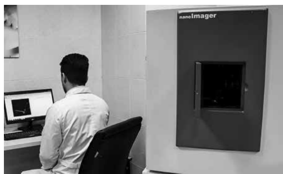
شکل ۷ سیستم تصویربرداری FMT
