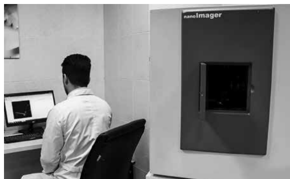
شکل ۷ سیستم تصویربرداری FMT
