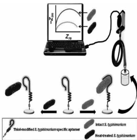
شکل (۵): شکلی شماتیک از شناسایی باکتری Salmonella Typhimurium توسط بیوسنسور الکتروشیمیایی
