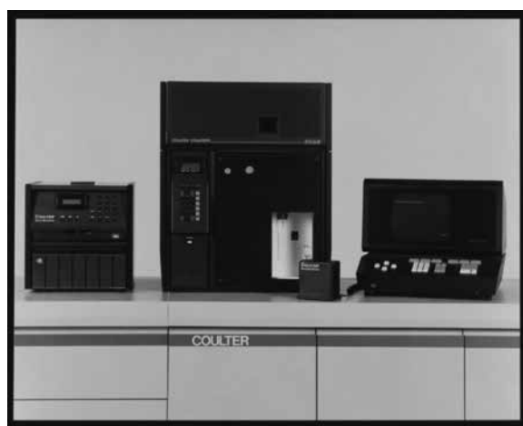
شکل ۴. دستگاه کولتر مدل S-plus II
