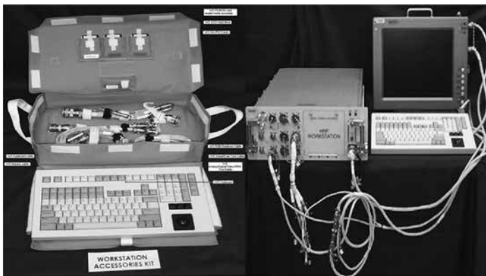
تصویر ۶. نحوه اتصال ایستگاه کاری «اچ‌آراف» به صفحه مانیتور و صفحه کلید
