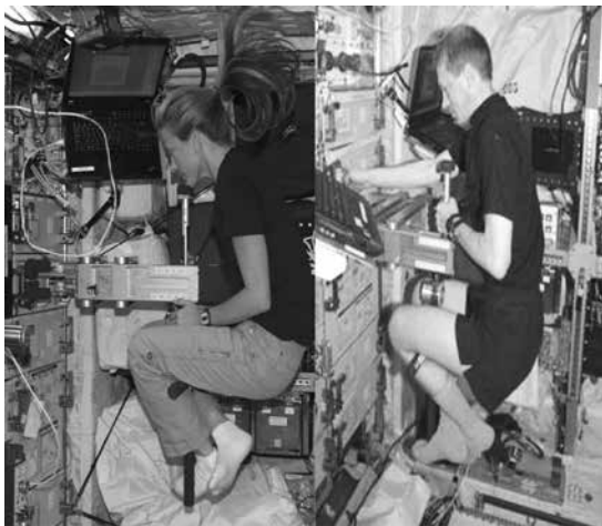
تصویر ۱- فضا نوردان در حال استفاده از دستگاه سنجش جرم شتاب خطی فضایی
