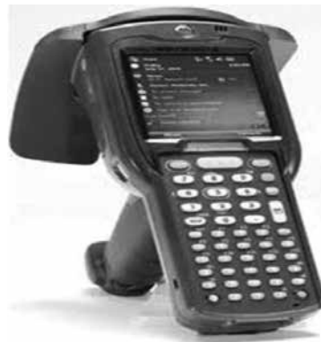
تصویر ۶. دستگاه شناسایی فرکانس رادیویی است.
