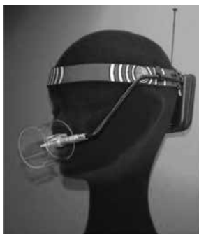
تصویر ۲- تصویر سمت راست سیستم جدید با قابلیت ارسال اطلاعات به صورت بی‌سیم و تصویر سمت چپ ساختار شماتیک حسگر اکسیژن را نشان می‌دهد.
