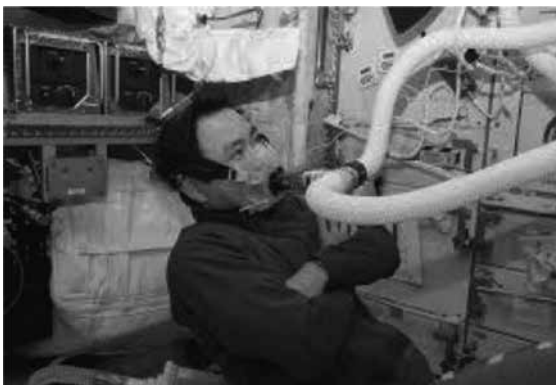
تصویر ۳- فضانورد آرئانس فضایی ژاپن و انجام عملیات سنجش جذب اکسیژن
