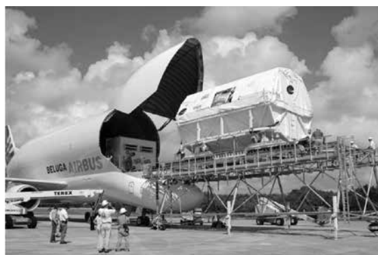
تصویر ۵. آزمایشگاه فضایی کلمبوس پس از ساخت، توسط هواپیمای ابرترابری ایرباس موسوم به «ننگ بلوگا» از اروپا به مرکز فضایی کندی در آمریکا منتقل شد.
