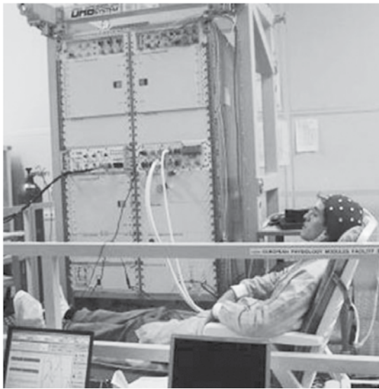
تصویر ۱۱. بخش فیزیولوژی اروپایی قبل از راه اندازی در فضا و تست آن در زمین در کنار آن سیستم الکتروانسفالوگرافی دیده می‌شود.
