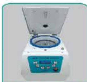
میکروهماتوکریت ۱۲۰۰۰ دور در دقیقه
