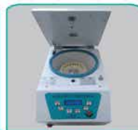
سانتریفیوژ (میکروپیوژ) ۲۴ شاخه ۱۴۰۰۰ دور در دقیقه
