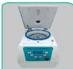
میکروهماتوکریت ۱۲۰۰۰ دور در دقیقه
