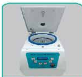
میکروهماتوکریت ۱۲۰۰۰ دور در دقیقه
