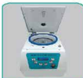
میکروهماتوکریت ۱۲۰۰۰ دور در دقیقه
