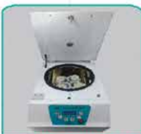
سانتریفیوژ ۱۶-۸ شاخه ۴۰۰۰ دور در دقیقه مخصوص لوله های ۱۵ ال پی آر پی
