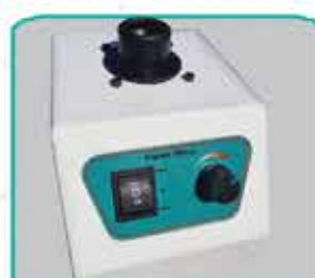
شیکر لوله ورتکس دو حالت حرکت دستگاه بصورت ویبره میباشد
