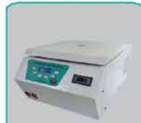
سانتریفیوژ (میکروفیروز) یخچال دار ۱۴۰۰۰ دور در دقیقه هدفیکس ۸ شاخه ۱۰۰۰۰ آر پی ام ویژه لوله های ۵۰ سی سی سرو و ۱۵ فالکون
