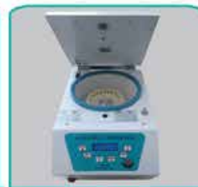
سانتریفیوژ (میکرو فیوز) ۲۴ شاخه ۱۴۰۰۰ دور در دقیقه
