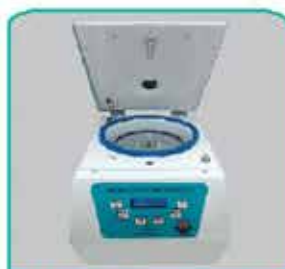
میکروهماتوکریت ۱۲۰۰۰ دور در دقیقه
