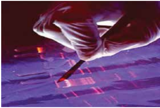
شکل ۲) تابش U.V به ژل آگاروز در دستگاه ترانس لومیناتور
