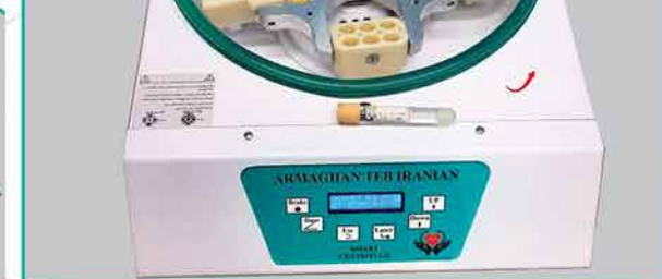
سانتریفیوژ یونیورسال ۴۰۰۰ دور بر دقیقه ۸ الی ۴۸ شاخه برای انواع لوله های آزمایشگاهی
