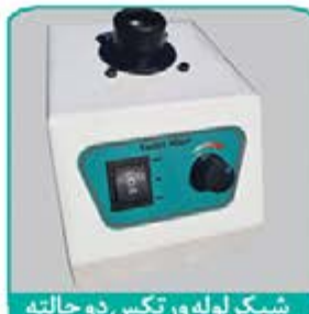
شیکر لوله ور تکس دو حالت حرکت دستگاه بصورت و بره میباشد
