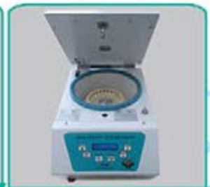
سانتریفیوژ (میکرو فیوز) ۱۴۰۰۰ دور در دقیقه ۲۴ شاخه
