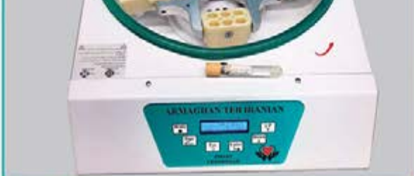
سانتریفیوژ یونیدور سال ۴۰۰۰ دور بر دقیقه ۸الی ۲۸ شاخه برای انواع لوله های آزمایشگاهی
