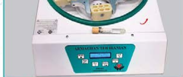
سانتریفیوژ یونیبور سال ۴۰۰۰ دور در دقیقه ۸الی ۲۸ شاخه برای انواع لوله های آزمایشگاهی
