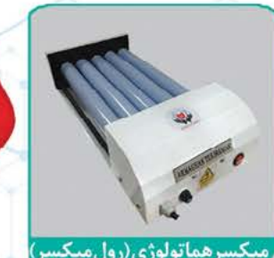
میکسر هماتولوژی (رول میکسر) ۳۰ دور در دقیقه
