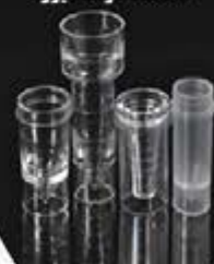
انواع کاپ بیوشیمی دستگاه اتو آنالایزر
