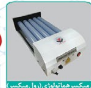
میکسر هماتولوژی (رول میکسر) ۲۰ دور در دقیقه
