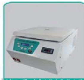
سانتریفیوژ (میکروفیوژ) یخچال دار ۱۴۰۰۰ دور در دقیقه هدفکس ۸ شاخه ۱۰۰۰ آریبی ام ویزه لوله های ۵۰ سی سی و ۱۵ فالنگون
