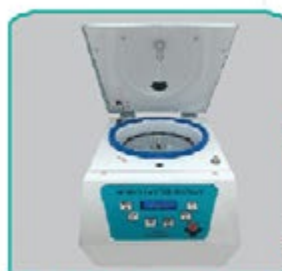
میکروهماتوکریت ۱۴۰۰۰ دور در دقیقه
