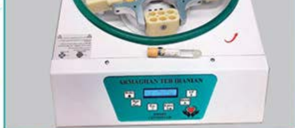
سانتریفیوژ بولنیور سال ۴۰۰۰ دور بر دقیقه ۸ الی ۴۸ شاخه برای انواع لوله های آزمایشگاهی
