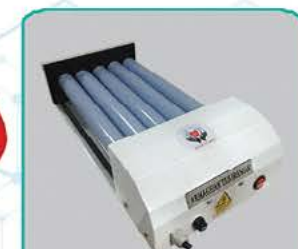
میکسر هماتولوژی (رول میکسر) ۳۰ دور در دقیقه
