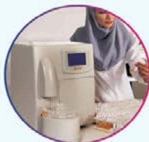
نسل دوم: الکتروولیت آنالایزر الکتروودی
